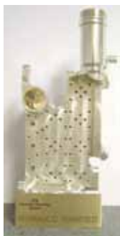
F1 car hydraulic manifold
